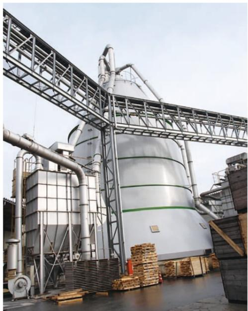
木質バイオマスを燃料とする製材所のエコ発電設備。工場の全電力を賄っている
