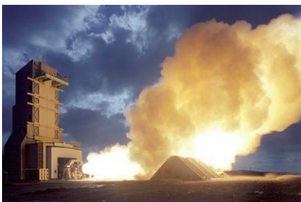
JAXA能代ロケット実験場で実施される固体ロケットモータ・地上燃焼実験の様相：©JAXA
